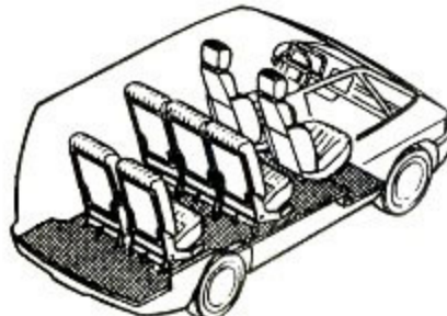
Варианты расположения сидений и грузовых площадок в семиместной машине с пятидверным кузовом.
